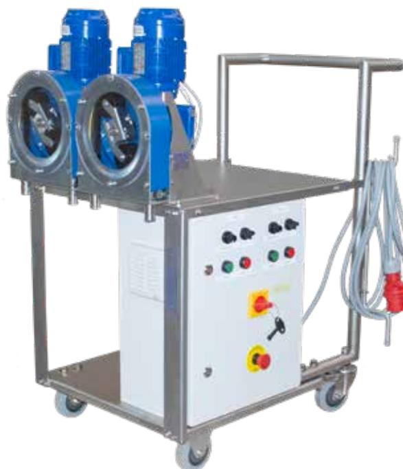
**2 x PTL17 na kolicima sa električnim kontrolnim ormarom i eksternim inverterima**
