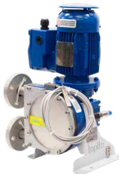
**ATEX PXTL13 sa DN20 prirubnicom, zaštitnim poklopcem motora, senzorom temperature i detektorom curenja creva**
