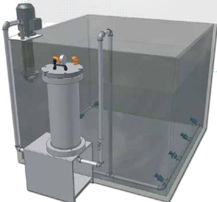
CTV pumpe se obično instaliraju u kadama za površinski zaštitu, cirkulišući kroz filter sve do mlaznica na rampi.
