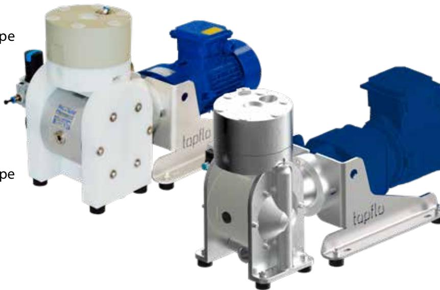
Tapflo membranske pumpe sa električnim pogonom pružaju protok sa smanjenom pulsacijom u poređenju sa tipičnim membranskim pumpama na vazdušni pogon. Da bi se u potpunosti eliminisalo pulsiranje za primene gde je to neophodno, TE pumpe mogu biti opremljene i pneumatskim prigušivačem pulsacija.
