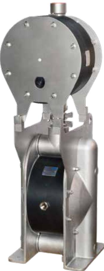
» U slučaju da treba da opremite pumpu veću od T200 sa prigušivačem pulsacija, ovaj SET obezbeđuje rešenje. Ram od nerđajućeg čelika sadrži ušice za podizanje i služi kao učvršćenje za pumpu, kao i prigušivač, čineći ceo sklop veoma stabilnim i robusnim.
